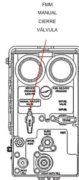
FIGURA 1: VÁLVULAS DE CIERRE MANUAL
