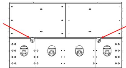
FIGURA 16 : PUERTOS DE VENTILACIÓN DE MONTAJE EN COLA
