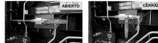
FIGURA 4 : VÁLVULA DE CIERRE MANUAL DEL CILINDRO
