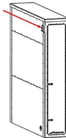
FIGURA 15 : PUERTOS DE VENTILACIÓN DE MONTAJE EN TECHO
